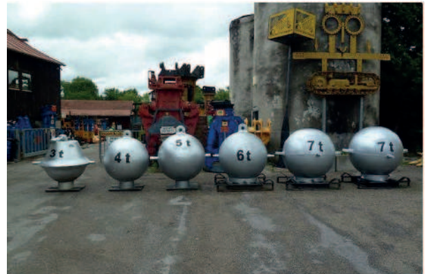
Abrissbirnen bestehen aus einem meist kugelförmigen Stück Stahl mit einer Masse von 500 bis 8000 kg
