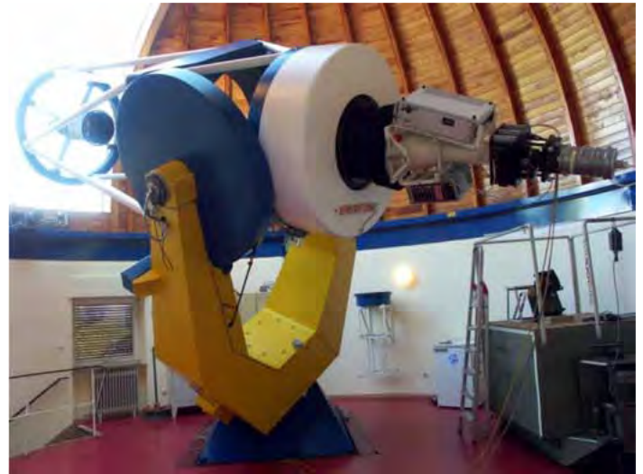
Abbildung 16. Das Cassegrain-Teleskop der Sternwarte Hoher List mit einem Spiegeldurchmesser von 1,06 Metern und einer Brennweite von 14,5 Metern.
