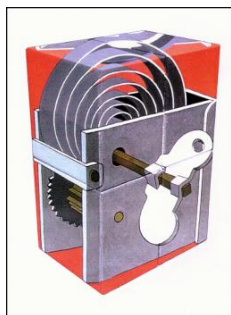
Exemplarische Darstellung eines Federmotors. Über die Schraube wird die Feder gespannt. Beim Abrollen treibt deren Bewegung das Zahnrad an.
